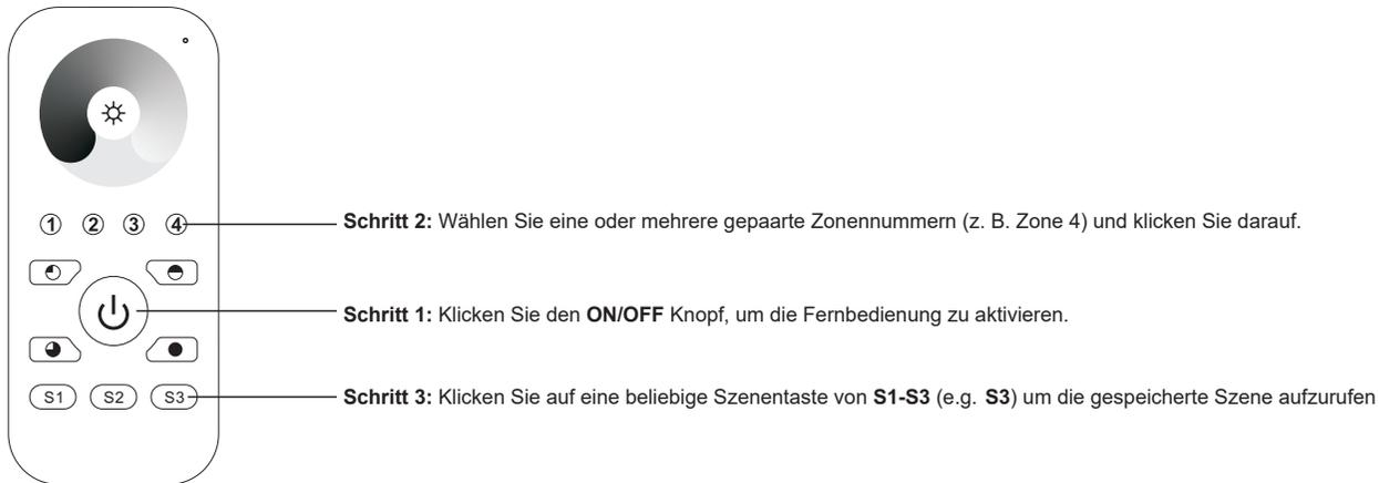
**Wenn Sie mehrere Empfänger verwenden, haben Sie zwei Möglichkeiten:** Option 1: Alle Empfänger müssen sich in derselben Zone befinden, z. B. in Zone 1
